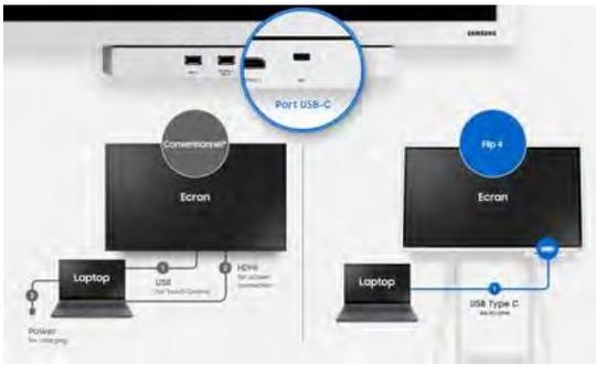
La connectique est améliorée grâce à l'ajout d'un port USB Type-C 3 en 1 : il permet de partager le contenu à l'écran, d'avoir un retour tactile et de charger l'appareil en même temps (max. 65W). Les intervenants peuvent simplement se connecter au port USB Type-C pour animer des réunions interactives et impactantes sans difficulté.
